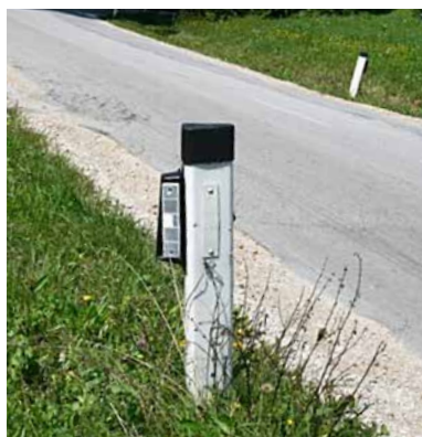
Slika 71: Zvočna odvračalna naprava za živali
