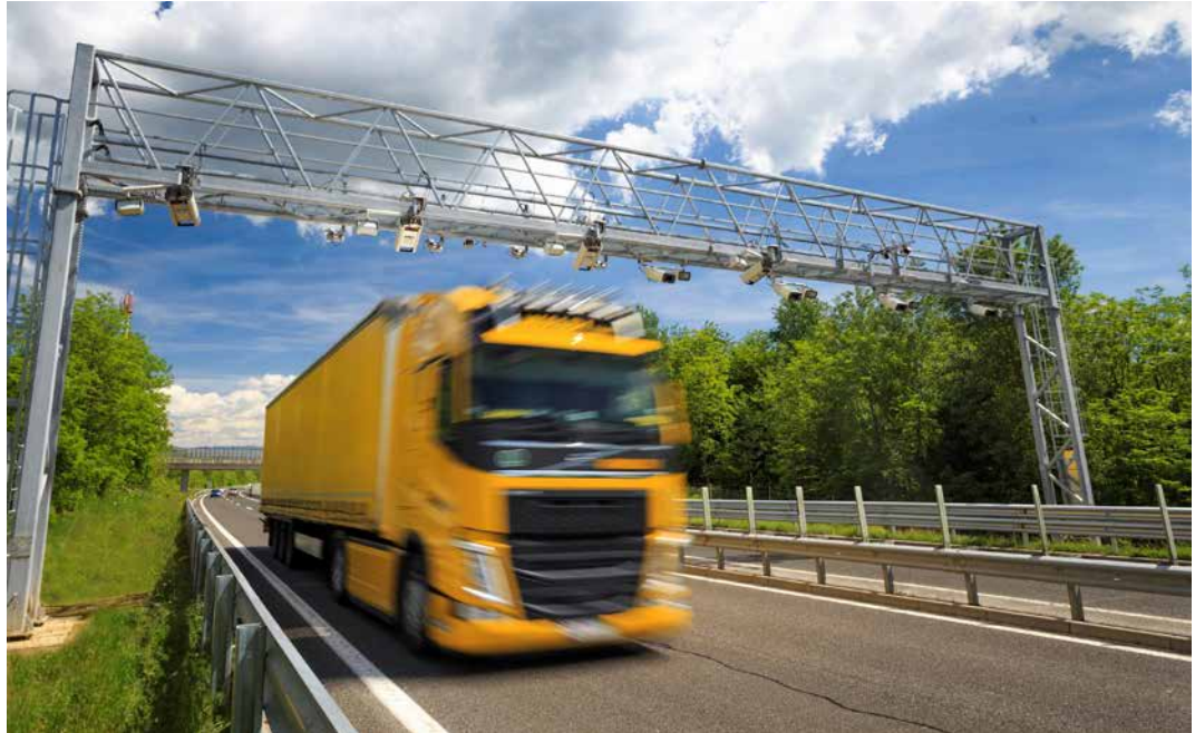
Slika 49: Plačevanje cestnine za tovorna vozila brez ustavljanja
